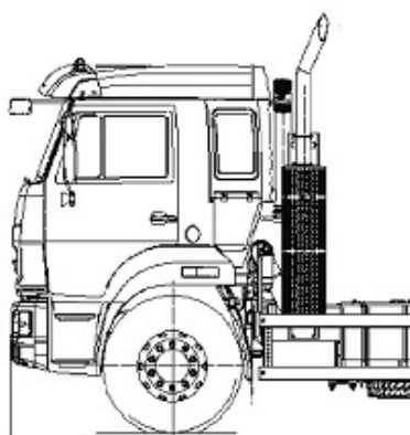
Вариант с направлением системы выпуска вверх. Кабина со спальным местом
