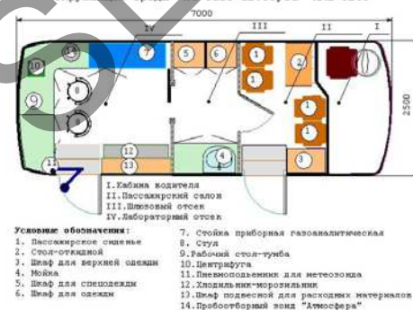
Передвижной лабораторный комплекс БМК-3033-116-05 "Санитарно-эпидемиологическая лаборатория - Мониторинг окружающей среды" на базе автобуса ПАЗ-3205
