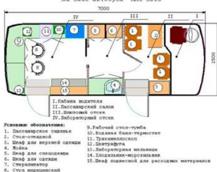
Передвижной лабораторный комплекс ВМК-3033-214-05 "Лаборатория ветеринарного надзора - Паразитологическая" на базе автобуса ПА3-3205
