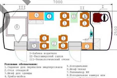
Передвижной медицинский комплекс БМК-3033-041-24 "Выездная медицинская бригада" (Спецавтобус с технологическим отсеком) на базе автобуса ПАЗ-32053
