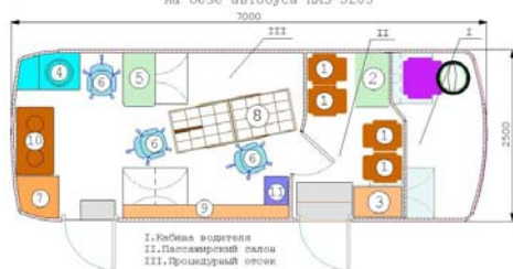
Передвижной медицинский комплекс БМК-3033-011 "Медицинский кабинет - Эндоскопический кабинет" на базе автобуса ПАЗ-3205
