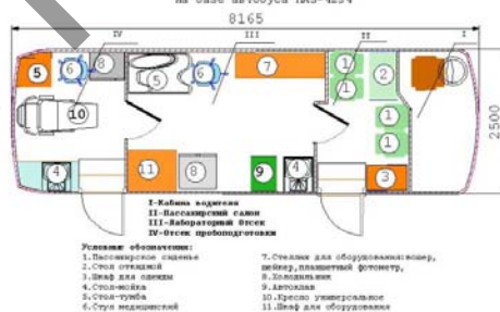
Передвижной лабораторный комплекс БМК-30331-112-05 "Санитарно-эпидемиологическая лаборатория - ИФА-лаборатория" на базе автобуса ПАЗ-4234
