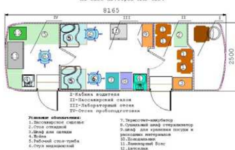
Передвижной лабораторный комплекс БМК-30331-114-05 "Санитарно-эпидемиологическая лаборатория - Паразитологическая" на базе автобуса ПАЗ-4234
