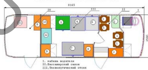
Передвижной медицинский комплекс БМК-30331-012-06 "Донор" (Донация, переработка, хранение, транспортировка донорской крови. Вариант 3) на базе автобуса ПАЗ-4234
