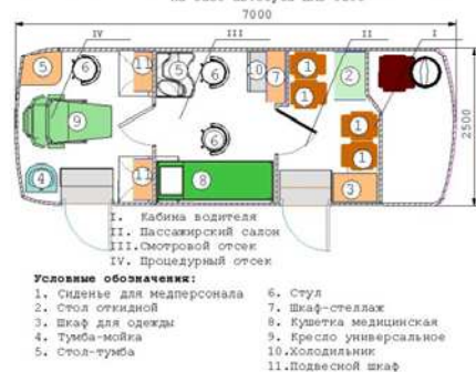
Передвижной медицинский комплекс ВМК-3033-09 "Диагностический кабинет - Ранняя диагностика онкозаболеваний" на базе автобуса ПАЗ-3205
