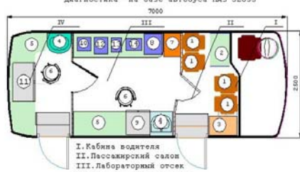
Передвижной лабораторный комплекс БМК-3033-110-05 "Санитарно-эпидемиологическая лаборатория - Комплексная диагностика" на базе автобуса ПАЗ-32053
