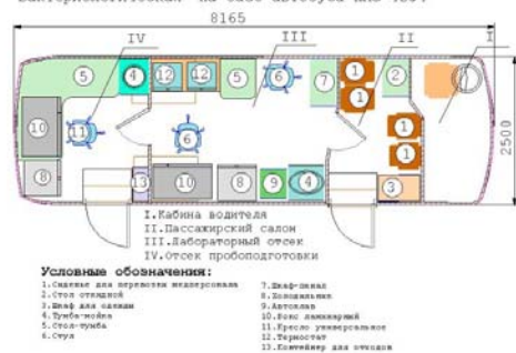
Передвижной лабораторный комплекс БМК-30331-013-05 "Бактериологическая" на базе автобуса ПАЗ-4234
