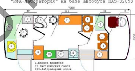
Передвижной лабораторный комплекс БМК-3033-012-05 "ИФА-лаборатория" на базе автобуса ПАЗ-32053
