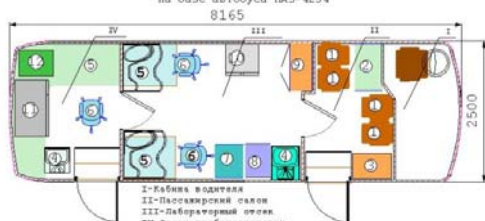
Передвижной лабораторный комплекс БМК-30331-214-05 "Лаборатория ветеринарного надзора - Паразитологическая" на базе автобуса ПАЗ-4234
