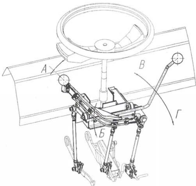
Установка ручного управления сцеплением, тормозом и акселератором – устройство для лиц с нарушением функций обеих ног
