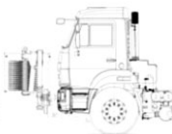
со щёткой для мойки барьерных ограждений
