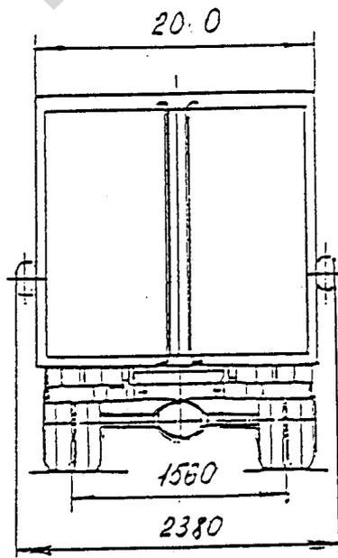
АВТОМОБИЛЬ - ФУРГОН ИЗОТЕРМИЧЕСКИЙ
